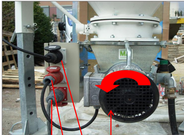
Drehrichtung Silovibrator Antriebsmotor Anschluss Euro C16 5-Pol 16 Amp.
