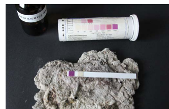
Analyse bauschädliche Salze
